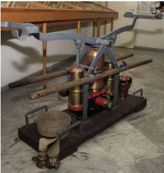
*Der Hydrophor war eine handbetriebene Kolbenpumpe, die durch einen Windkessel einen gleichmäßigen Wasserdruck gewährleistete.*
